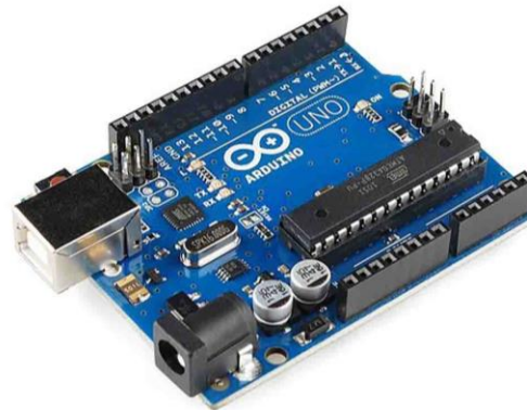
Fig. 5. Arduino UNO Microcontroller.
