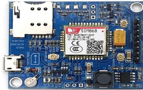
Fig. 4. SIM868 GSM/GPRS/GPS module.
