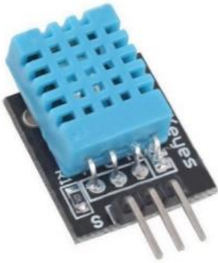
DHT11 sensor (www.wyhhx.com, 2023)
