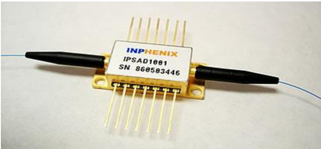
Fig. 10 InPhenix's 1310nm O-Band SOA [104]
