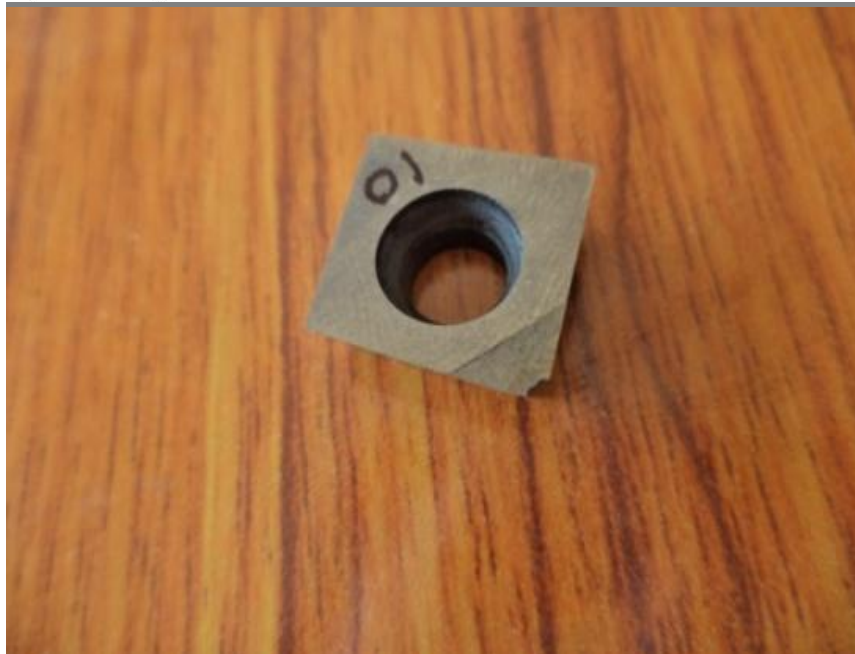
Fig. 5.9. Broken PCD Insert Tip
